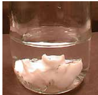
La graisse Krytox™ n'est pas dissoute dans un solvant hydrocarboné.
