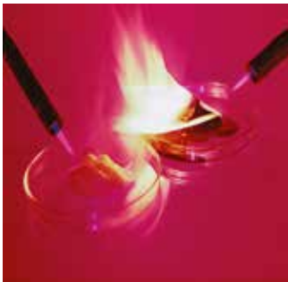
Les lubrifiants hydrocarbonés brûlent ; pas le Krytox™.
